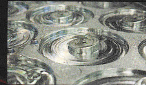
Die fertig ausgefrästen Kreistaschen für die Befestigung der LED-Spots.
