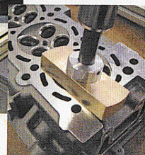
Gewindelehre mit Adaption für schräge Anlageflächen.
