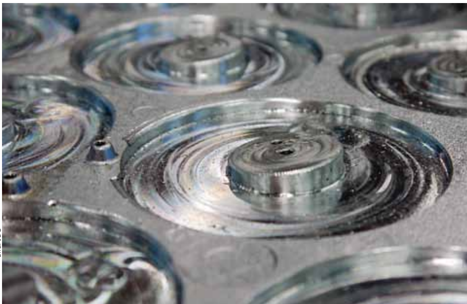
Bild 3: Fertig ausgefräste Kreistaschen für die Befestigung der LED-Spots.
