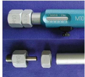
5. Nach Reinigen des Konus durch Ausblasen und entfetten, kann mit dem Einsetzen eines neuen Gewinde-Gutlehrdornes begonnen werden
