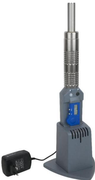
Abbildung 3: Aufladen der eMultiCheck (bei Akkubetrieb)
